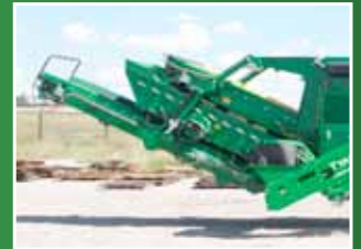
Überkornabsiebung mit Rückführband
