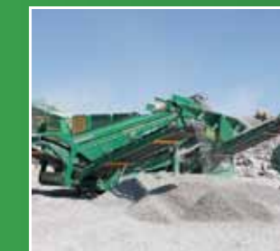
Mittel- und Feinfraktionaustragebänder auf einer Seite montiert
