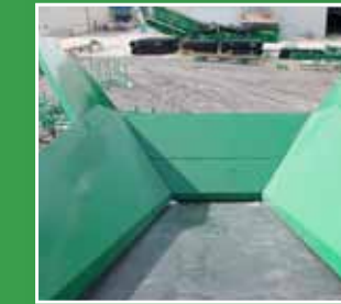
Aufgabeband mit stahlverstärkten 3-Lagen Gurt
