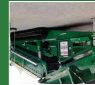
Kippbarer Stangenrost über Aufgabetrichter R 155 und R230
