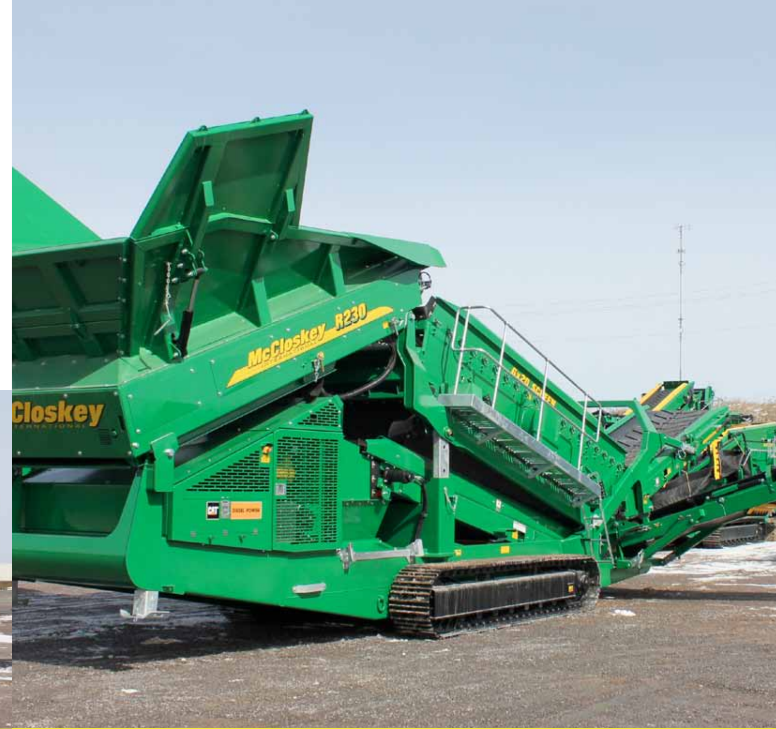
Trichteraufsatzwände hydraulisch klappbar
